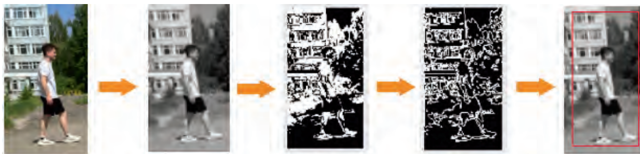
Рис. 8. Принцип работы алгоритма распознавания человека на изображении.
